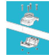
**Etape 1** - Arrêter la pompe. Assembler les 2 parties du collier sur le tuyau avec les 4 vis et écrous fournis.
