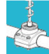
**Etape 2** - Faire un trou dans le tuyau rigide de PVC en utilisant une perceuse électrique et l'outil de découpe fourni.
