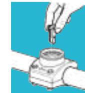
**Etape 3** - Insérer le capteur de débit dans le trou et le clipper.
